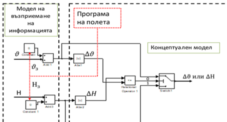
Фиг. 2. Структурна схема за контура на управление в надлъжния канал
